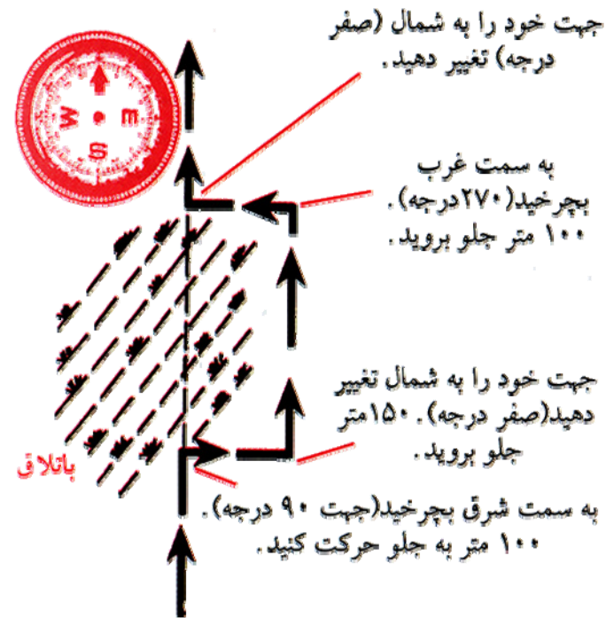
تصویر ۳۴- دور زدن به کمک گرا- روش میان بر ۹۰ درجه
